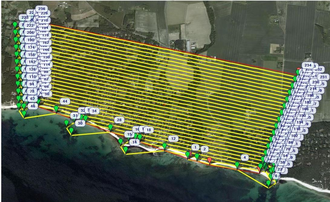
**Exemple de la trajectoire de vol d'un seul drone pour la cartographie**
